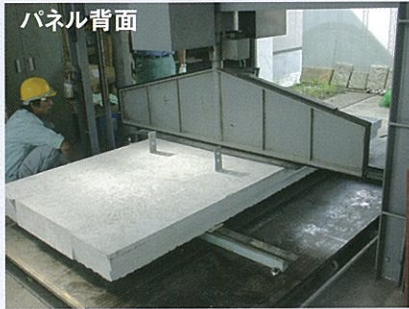
【コンクリートパネルの曲げ試験状況】
