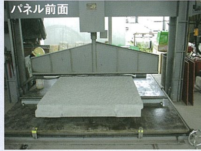
【コンクリートパネルの曲げ試験状況】
